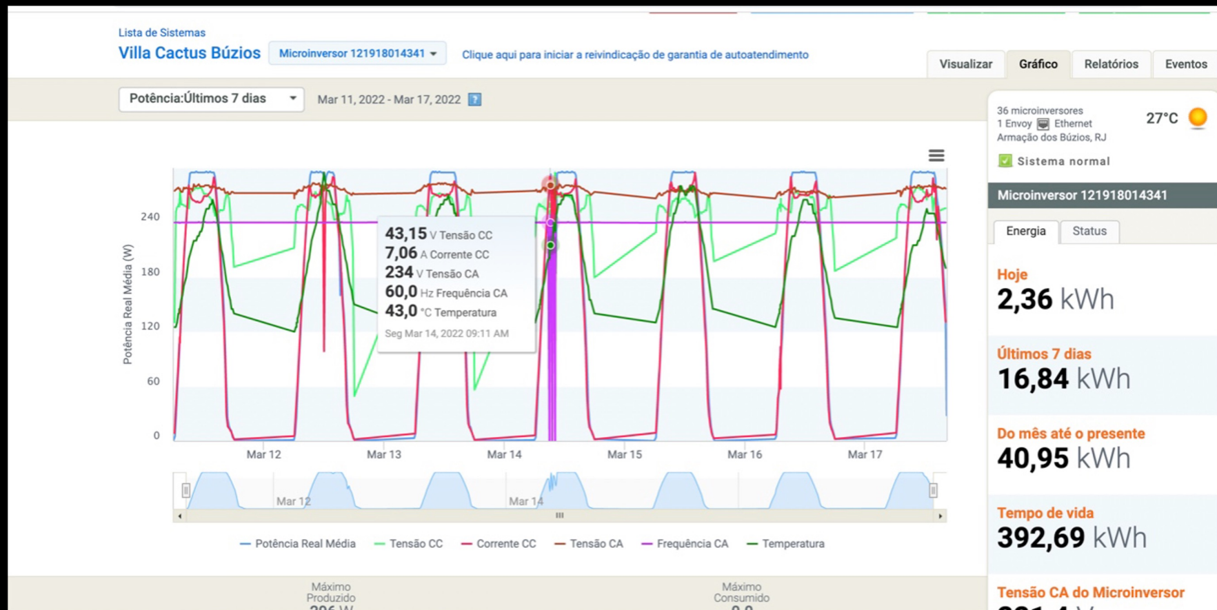
Monitoramento de diversos parâmetros do sistema
